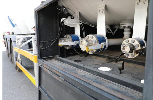
صهريج مزود بصمام تفرغ يدوي، ومؤشر قياس درجة الحرارة، وصمام علوي لدخول الهواء، وصمام تصريف الضغط
